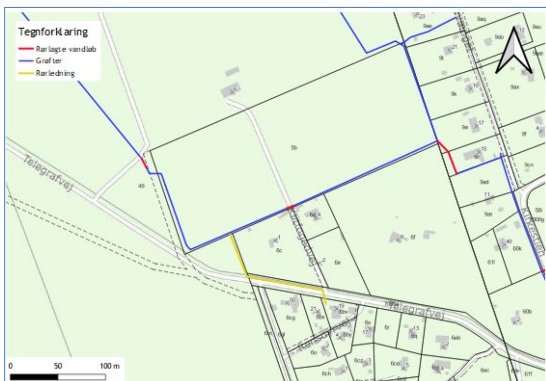
Figur 2 - Rørledningens forløb og udløb i grøft.
