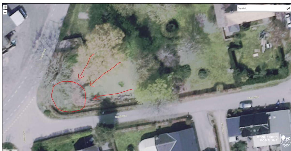
Kort 2: Figur fra ansøgningen, der viser hvor oprenset materiale lægges til afvanding, inden det bortkøres.
