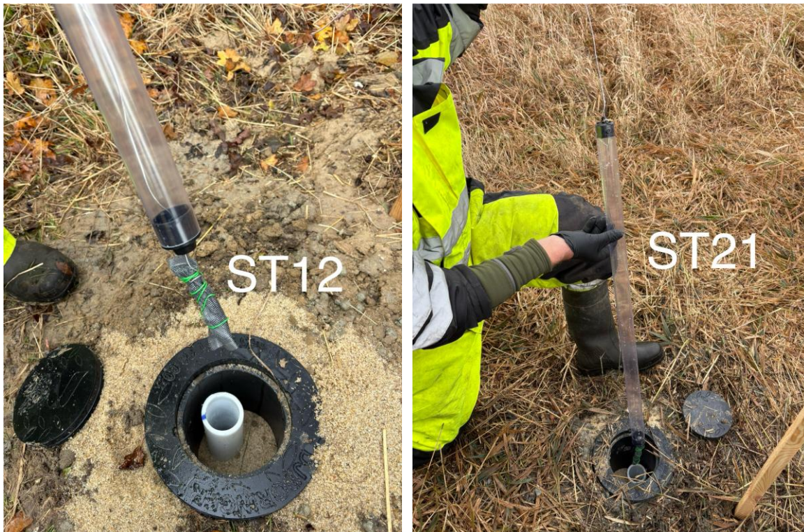
Figur 5.6: Eksempel på GACs installeret i borer. Netposen med aktivt kul rulles som cigar og placeres i boring ca. i midten af filterinterval med bailer.
