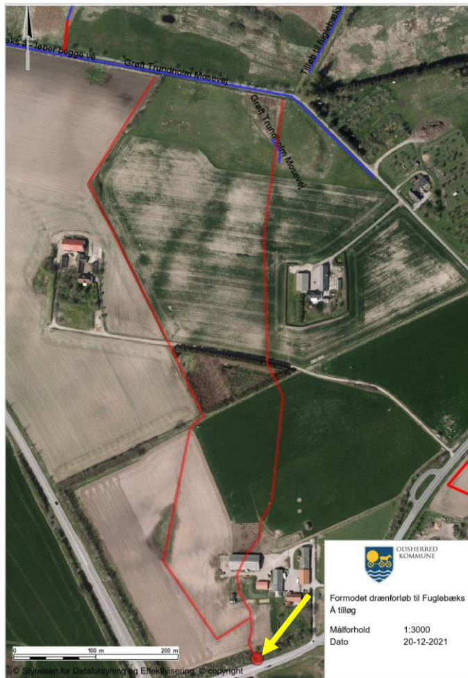
Figur 5.1: Anslået dræneløb nordøst for Nørremarksvej 13 ifølge Odsherred Kommune. Dræn er forbundet til brønd på matrikel nr. 4d Hønsinge By, Vig (markeret med gul pil), som modtager spildevand og regnvand fra Nørremarksvej 13. Figur er også vedlagt som Bilag 1.8.
