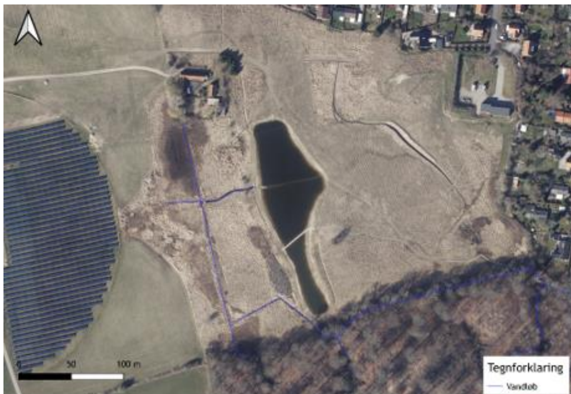
Figur 1. Placering af søen. Gangbro og tærskler, som skal tilbageholde vandet, så der kan nå at ske en omsætning af næringsstoffer, kan ses på figuren. Vandet løber fra nord mod syd.
