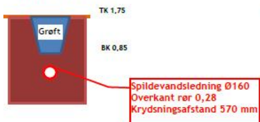
Krydsning nr. 5 Under - gravning
