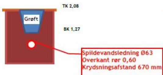
Krydsning nr. 1 Under - gravning
