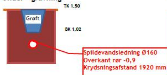
Krydsning nr. 7 Under - gravning
