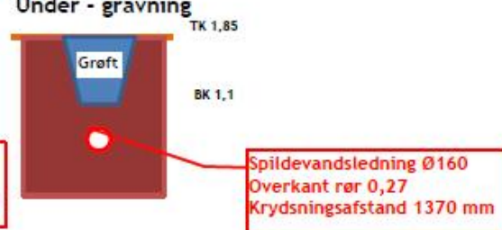
Krydsning nr. 8 Under - gravning
