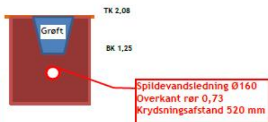
Krydsning nr. 2 Under - gravning
