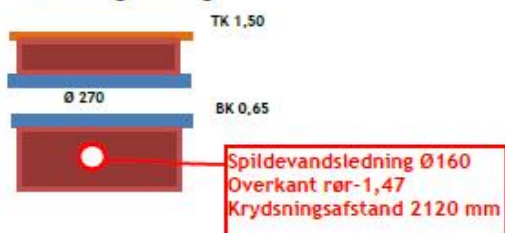
Krydsning nr. 3 Under - gravning
