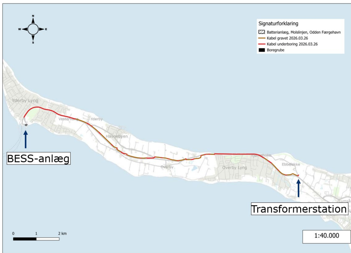
Figur 1-4: Kortet viser kabelforbindelse imellem BESS-anlægget på Odden Færgehavn og transformerstationen ved Ebbeløkke.
