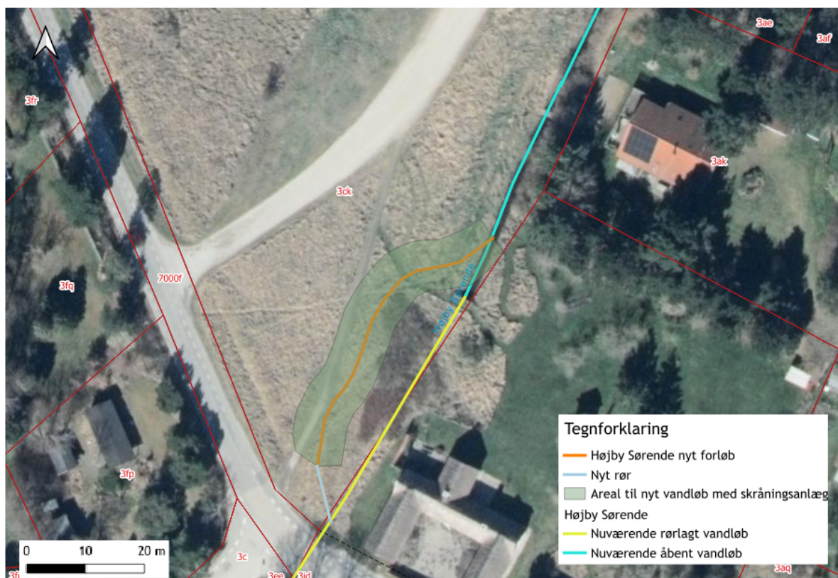
Figur 10 – Omtrentligt areal med vandløb og skråninger ved afgravning til kote 4,25
