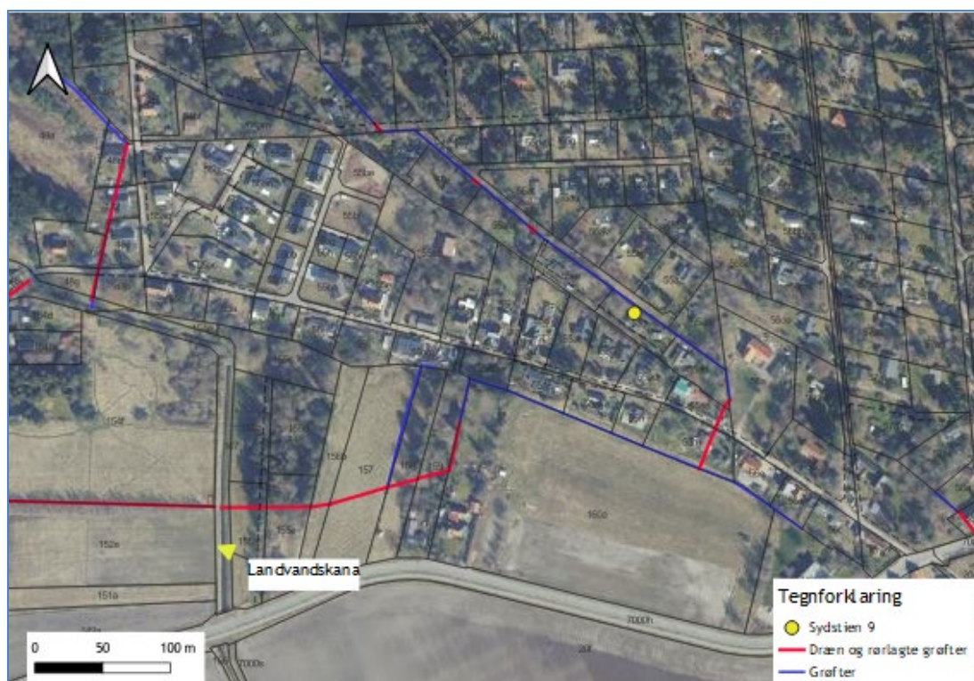
Figur 2 - Grøfter og dræn i området ved Sydstien 9.
