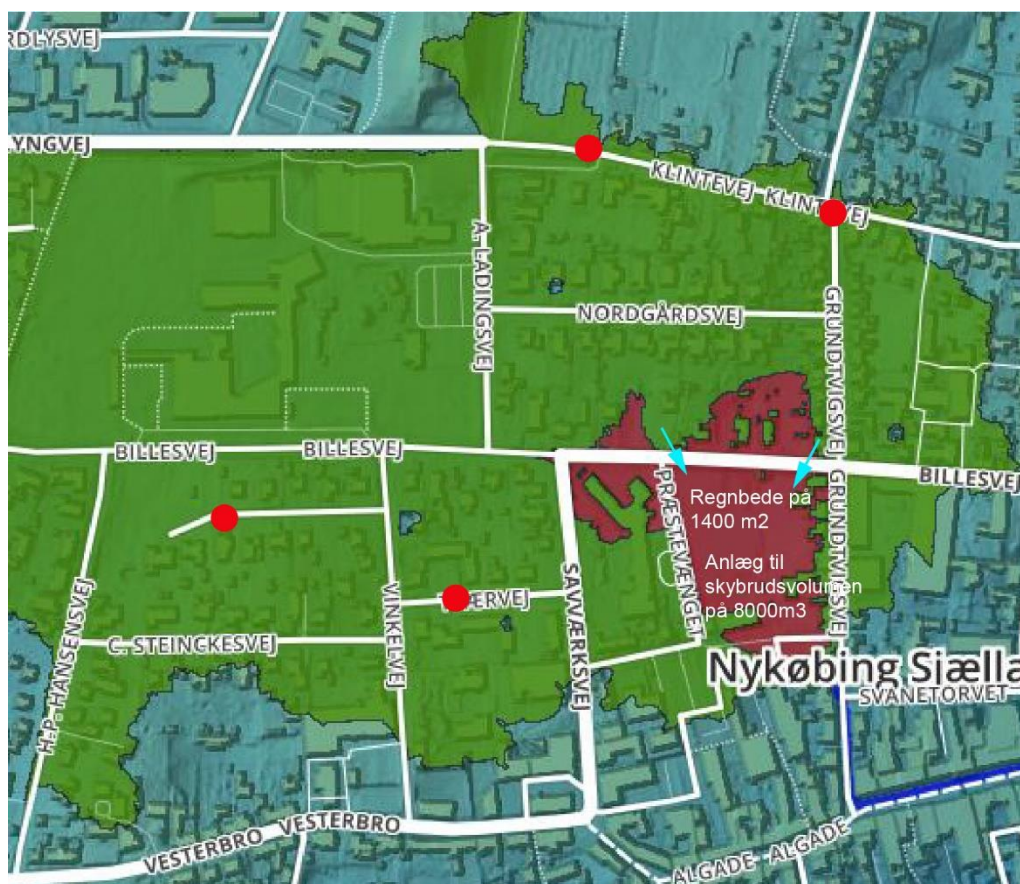
Figur 3.24: Løsningsforslag til håndtering af hverdagsregn og skybrudsregn.
