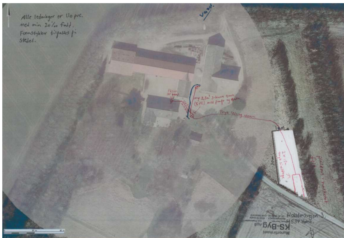
Kort 2: Placering af nedslivningsanlæg, vand og kloakledninger jf. ansøgningen. Selve nedslivningsanlægget placeres uden for fortidsmindebeskyttelseslinjen. Røde streger er kloakledninger. Blå streger er vandledninger.
