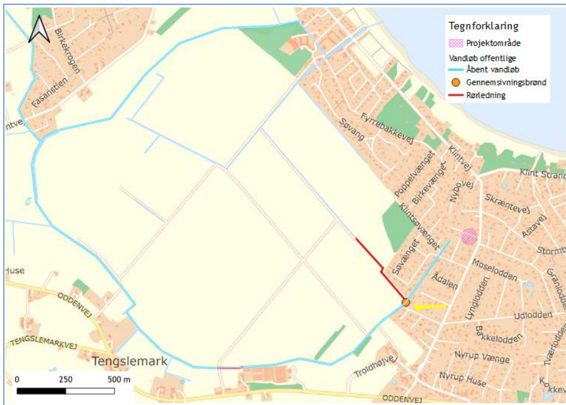
Figur 3 – Ved brønden markeret med orange ledes vandet fra Klintsø Landkanal ind til pumpekanalen på Klintsø.
