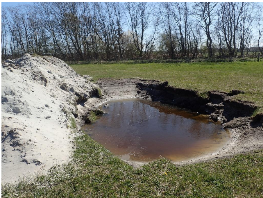
Foto fra besigtigelsen, der viser det gravede prøvehul.
