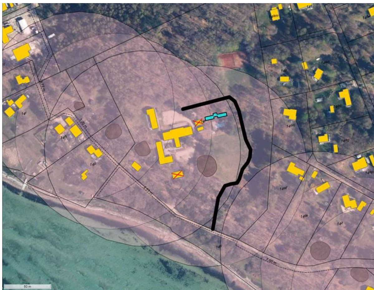
Figur 1. Luftfoto fra 2023. Ny bygning er vist med turkis og ny indkørsel er vist med tyk sort streg. Eksisterende bygninger i området er vist med gult med rødt kryds over de to bygninger som fjernes. Fortidsmindebeskyttelseslinjerne er vist med lyserød og gravhøjene er vist med grå.
