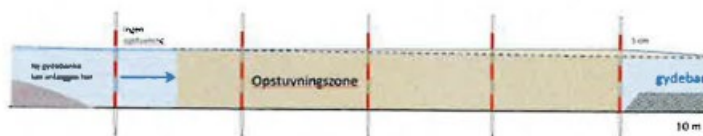
Figur 9 Principskitse for, hvordan man vha. landmålerstokke med markeringer af vandstandsforholdene kan sikre sig, at man ikke påvirker opstrøms beliggende områder, når man udlægger en eller flere gydebanke.
