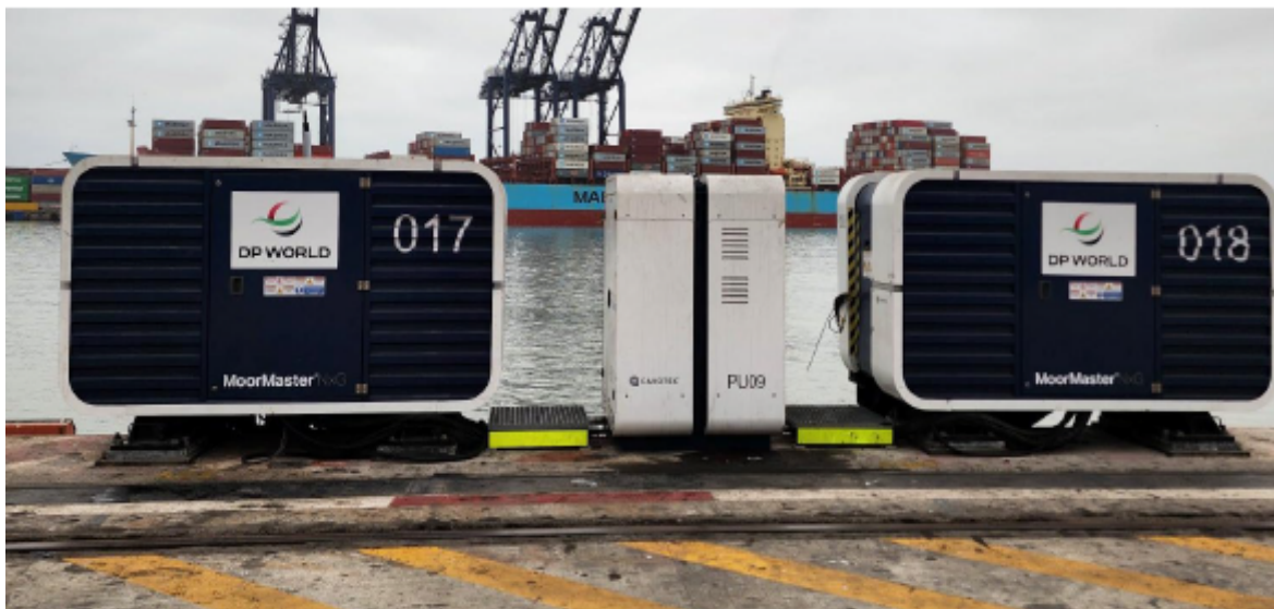
Figur 2 moormaster - reference foto af et tilsvarende anlæg bestående af to fortøjningssystemer og teknikskab i midten
