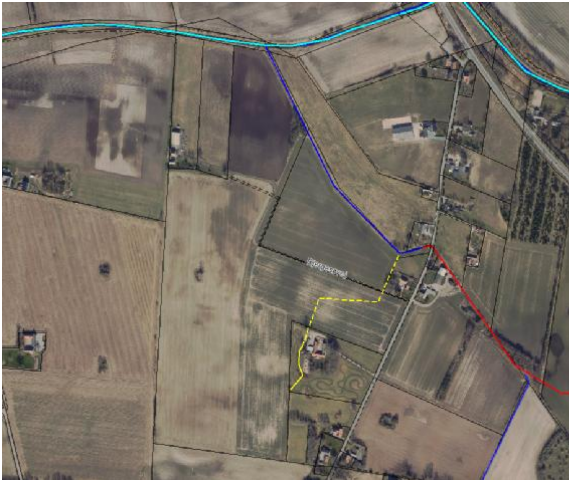
Figur 3 – Det eksisterende dræn på Bjergesøvej 39A er vist med gul streg. Gæt på videre forløb af drænet frem til grøften er vist med gul stiplede streg. Grøfter er vist med blå streg og rørlagte strækninger med rød streg. Hørve-Dragskanalen er vist med turkis. Målestok 1:5.000.
