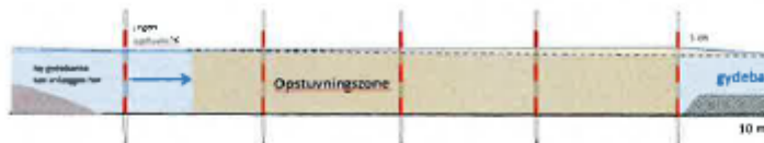
Figur 9 Principskitse for, hvordan man vha. landmålerstokke med markeringer af vandstandsforholdene kan sikre sig, at man ikke påvirker opstrøms beliggende områder, når man udlægger en eller flere gydebanker.
