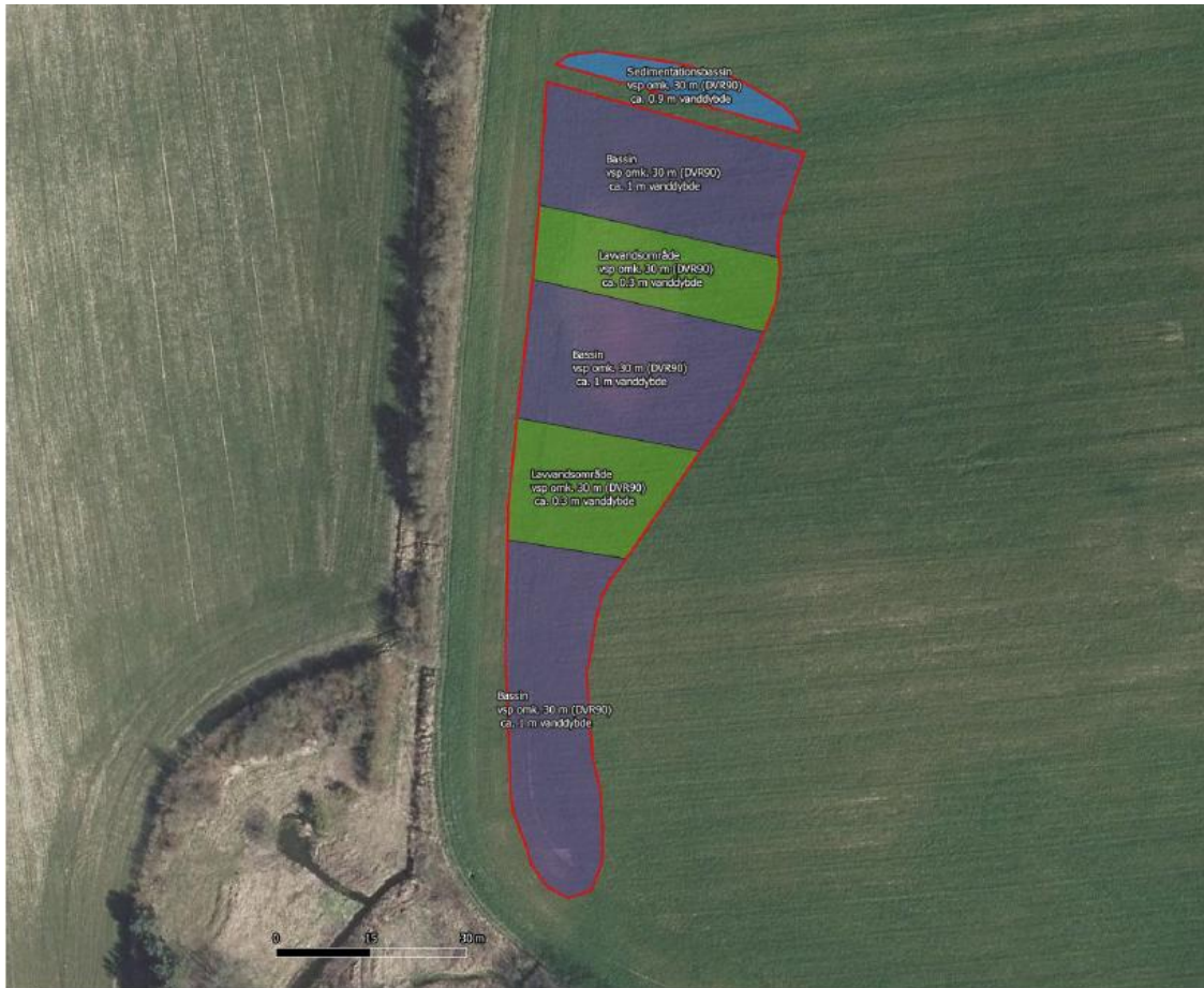
Figur 4 - Kort fra ansøgningen. Minivådområde med sedimentationsbassinet øverst vist med blå. Lilla viser bassiner med vanddybde på ca. 1 m og grøn viser lavvandsområder med vanddybde på ca. 0,3 m.
